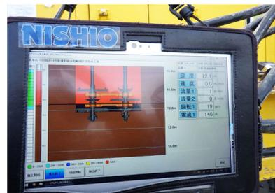
【表彰理由】地盤改良工の実施にあたり、新技術である施工状況を可視化できる施工管理システムを用いることにより、複数の現場スタッフが施工状況の確認や視覚的な施工情報の把握をできるようになり、地盤改良工事の信頼性が向上した。また、GNSS(全球測位衛星システム)の併用により、打設位置まで施工機械の誘導ができ、施工の精度が向上した。
